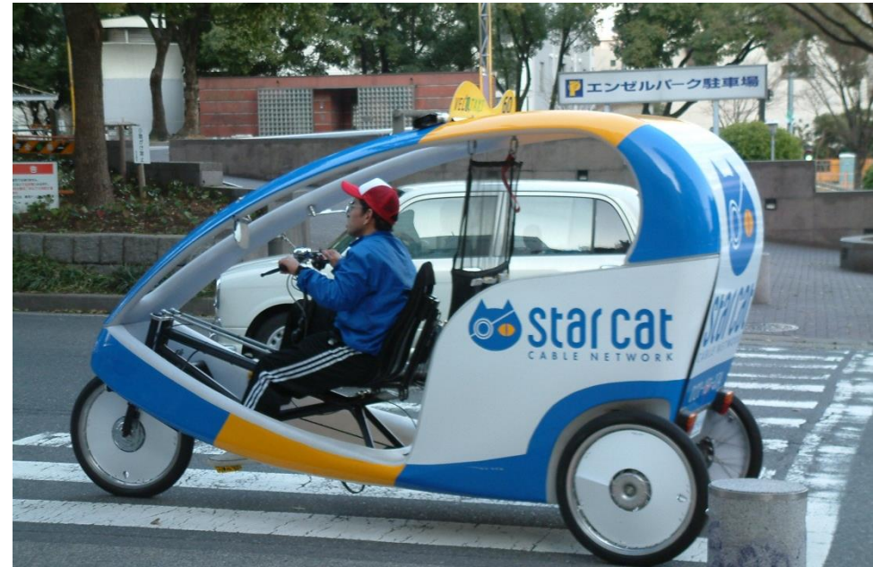
Vehículo en Nagoya (Japón) con asistencia eléctrica y en fibra de carbono
