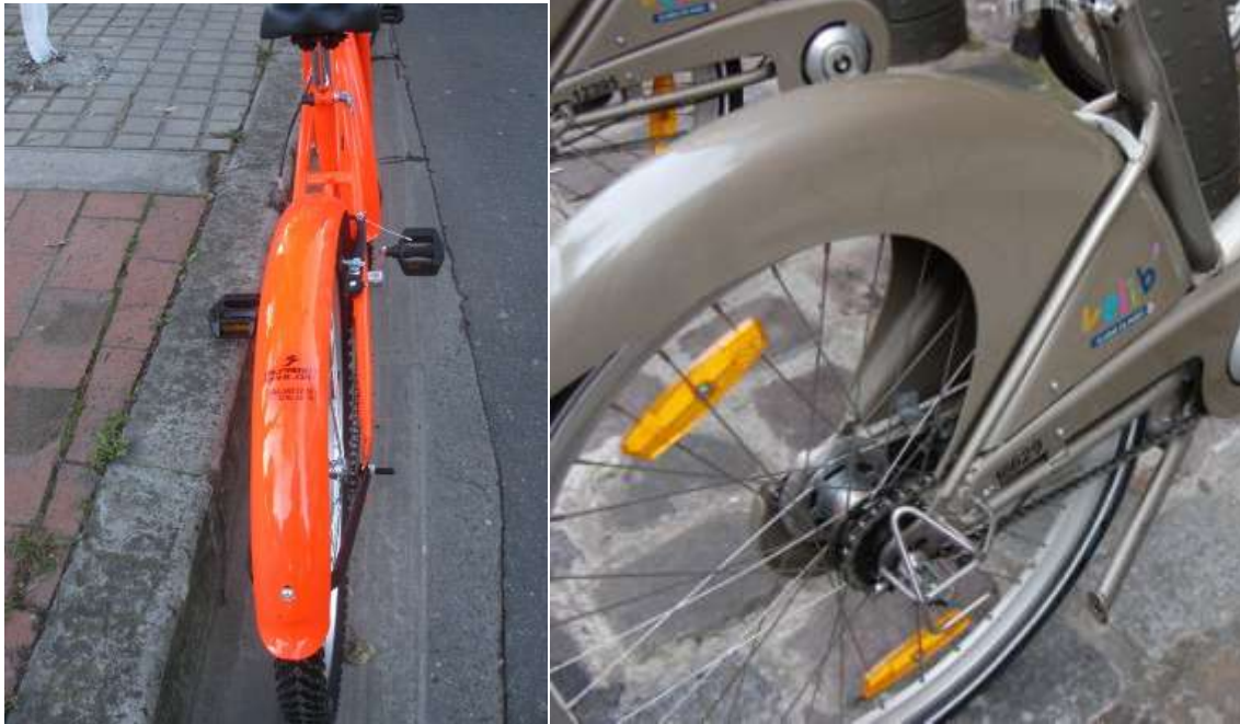
Figura 14. Detalles del guardabarros utilizado en BiciBog y en velib (parís)
