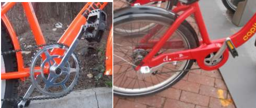
Figura 18. Bielas de cuña y pedales de pasta – comparación con bicicleta de Washington.
