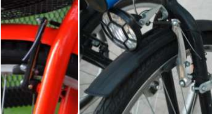
Figura 21. Frenos de pasta y frenos utilizados en sistema de Santiago.
