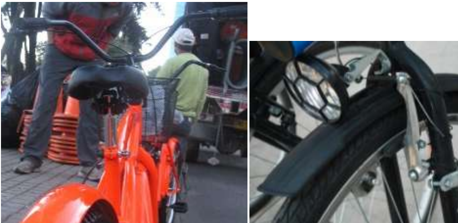
Figura 17. Parte trasera sin luz reflectiva en BiciBog, luz de dinamo en Santiago de Chile.
